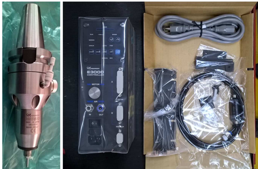
Fig. 15. Equipos adquiridos con los rubros del proyecto. Izquierda, Mini-husillo de alta precisión. Derecha, Controlador y cables.
