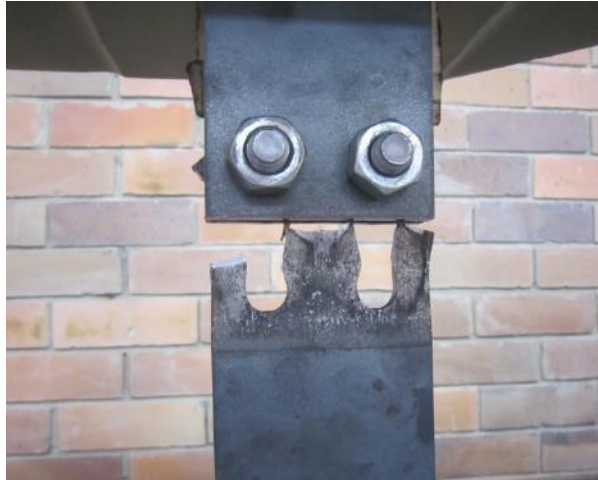
Figura 42. Falla por aplastamiento en la unión de dos hileras un tornillo con precarga de 90%.
