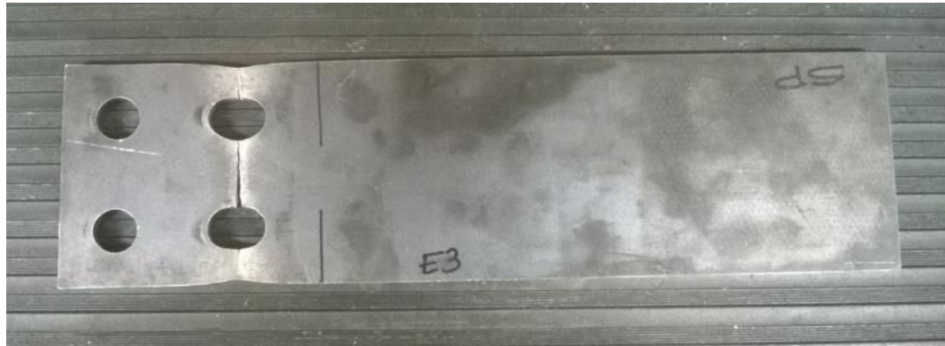
Figura 35. Falla unión de dos hileras dos tornillos sin precarga.
