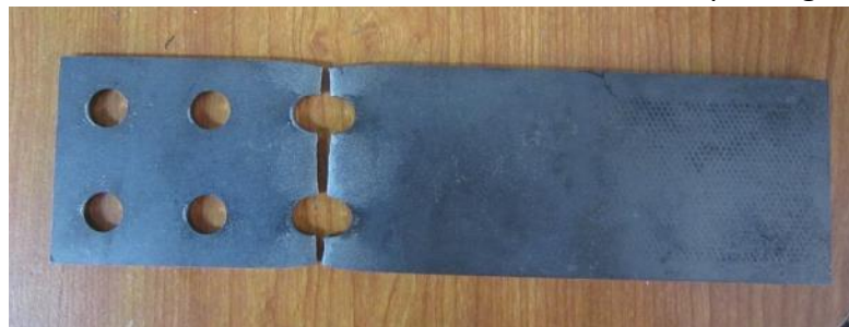
Figura 40. Falla de unión de dos hileras tres tornillos con precarga de 75%.
