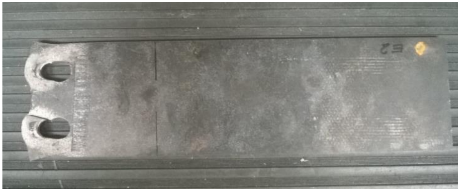
Figura 34. Falla unión de dos hileras un tornillo sin precarga.
