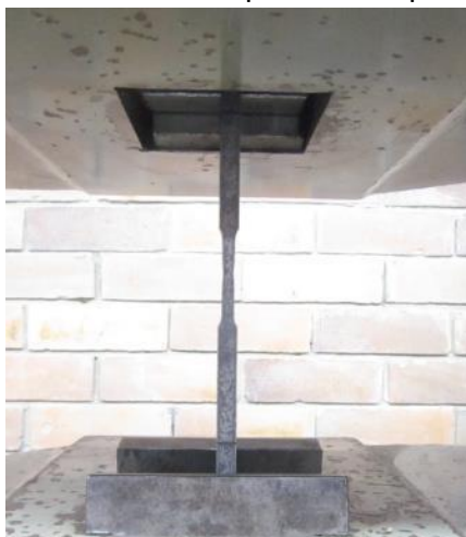
Figura 19. Perpendicularidad de probeta respecto a la mordaza.
