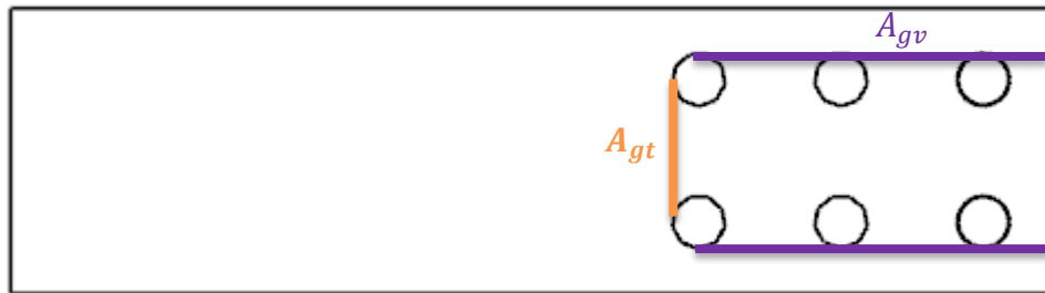
Figura 3. Designación de A_{gv} área bruta a cortante y A_{gt} área bruta a tensión.
