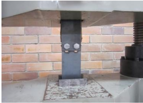
Figura 38. Falla unión de dos hileras un tornillo con precarga del 75%.
