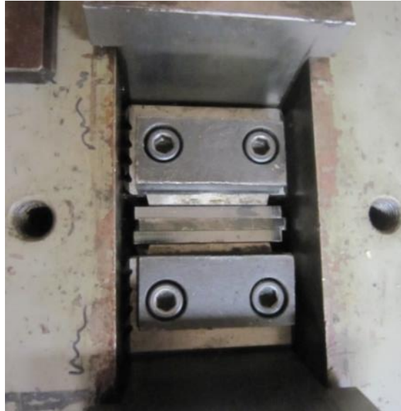
Figura 30. Agarre extremo de láminas externas.
