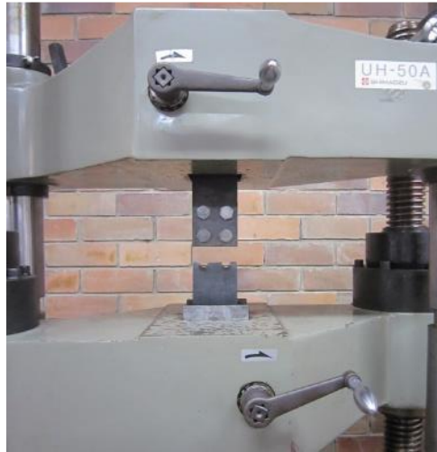
Figura 39. Falla de unión de dos hileras dos tornillos con precarga de 75%.
