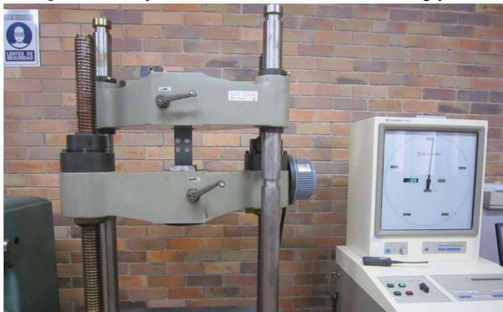
Figura 33. Montaje de unión atornillada de dos hileras de agujeros
