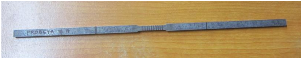
Figura 17. Longitud calibrada de probeta plana.
