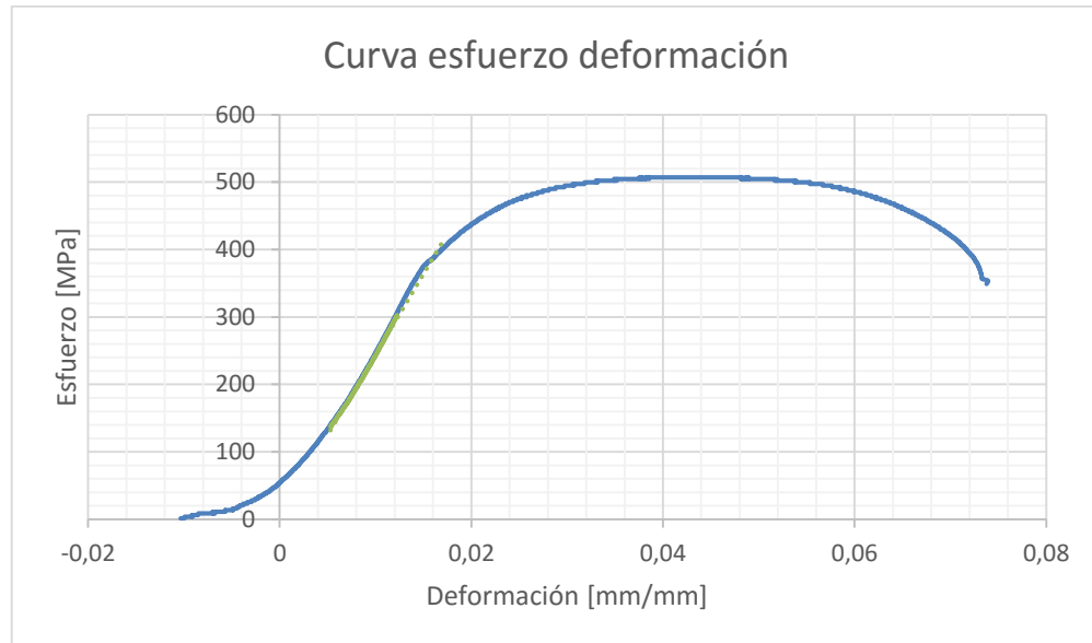
Figura 22. Curva esfuerzo deformación, ensayo 1.
