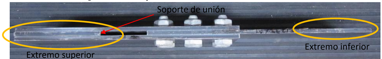
Figura 29. Montaje de unión atornillada de tres hileras.
