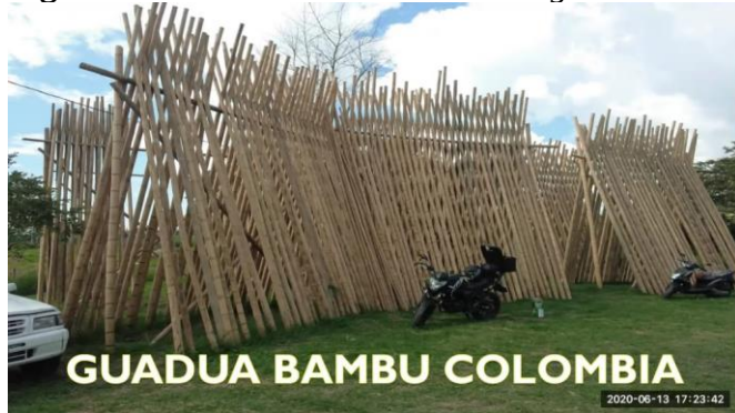
Figura 121. Método de secado de las guaduas inmunizadas con radiación solar.
