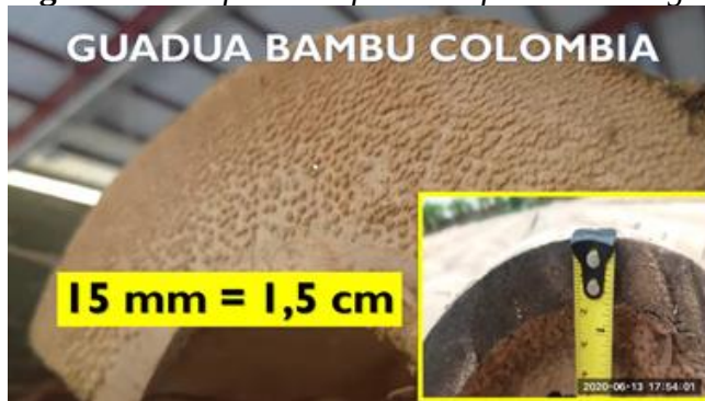
Figura 123. Espesor de pared requerido de la guadua estructural.
