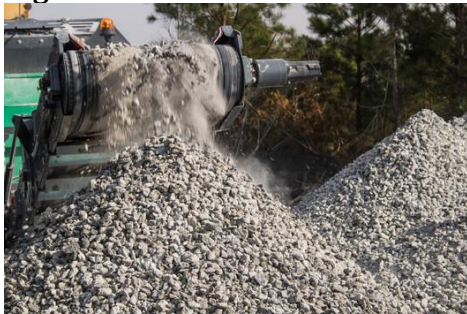
Figura 175. Concreto reciclado siendo procesado.
