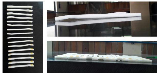
Figura 43. Deformación en el cuerpo de las probetas, post exposición a degradación UV.
