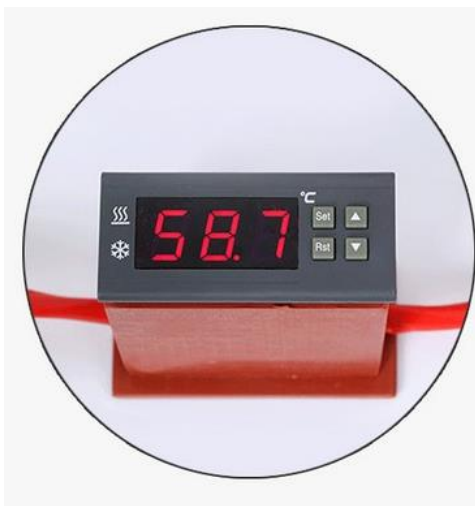
Figura 31. Tablero de control cama de impresión.
