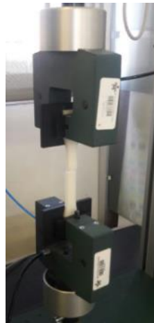
Figura 55. Sujeción de la probeta con mordazas neumáticas
