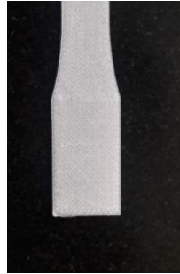
Figura 7. Impresión de probeta con porosidad del 35%.
