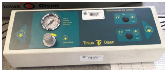
Figura 48. Unidad de Presión Neumática, Tinius Olsen Modelo 50T
