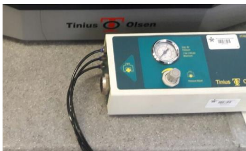
Figura 56. Unidad de presión maquina universal de ensayos.
