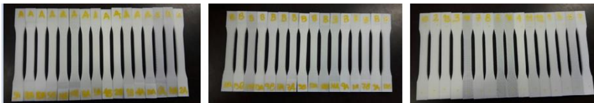
Figura 51. Organización de probetas para ensayos de tracción.
