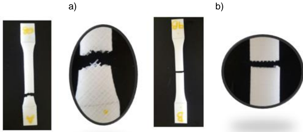
Figura 58. Fractura de probetas a) Probeta 17 Ciclo de Exposición A. b) Probeta 26 Ciclo de Exposición B.
