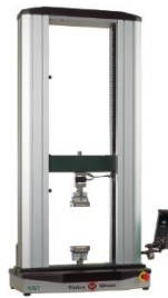
Figura 47. Máquina de ensayos universales, Tinius Olsen Model 50ST.
