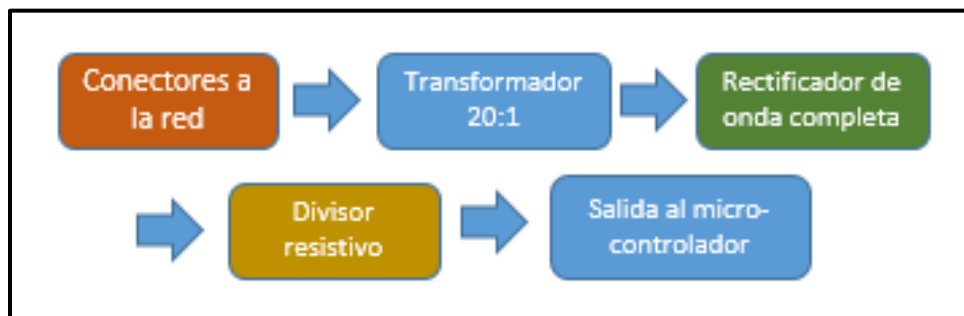
Figura 15. Diagrama de bloques de la adquisición y acondicionamiento de la señal de voltaje Fuente. Medina R, Yadir.
