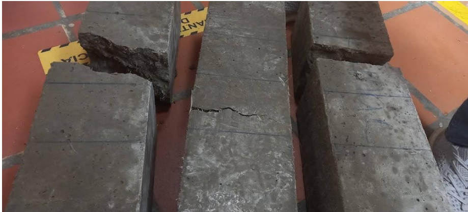
Figura 15 Fallas en viguetas ensayadas a flexión
