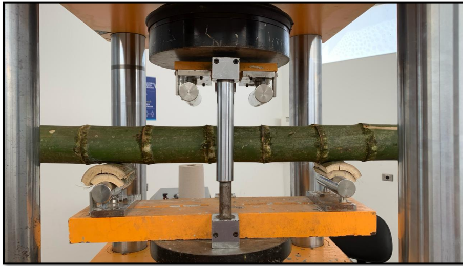
Figura 34 Montaje de la probeta para el ensayo a flexión
