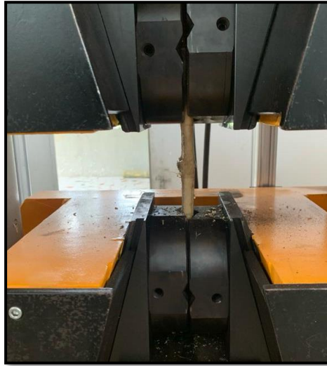
Figura 31 Montaje de la probeta para el ensayo a tensión paralela a las fibras
