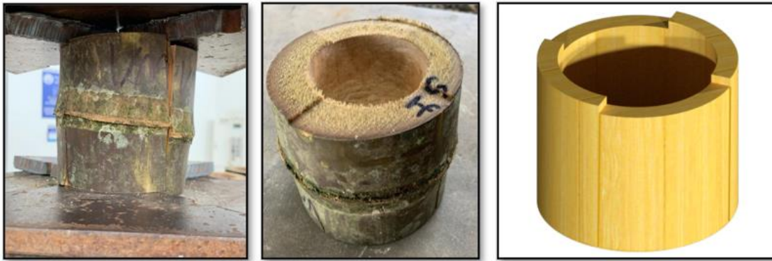
Figura 8 Falla de probeta por cortante
