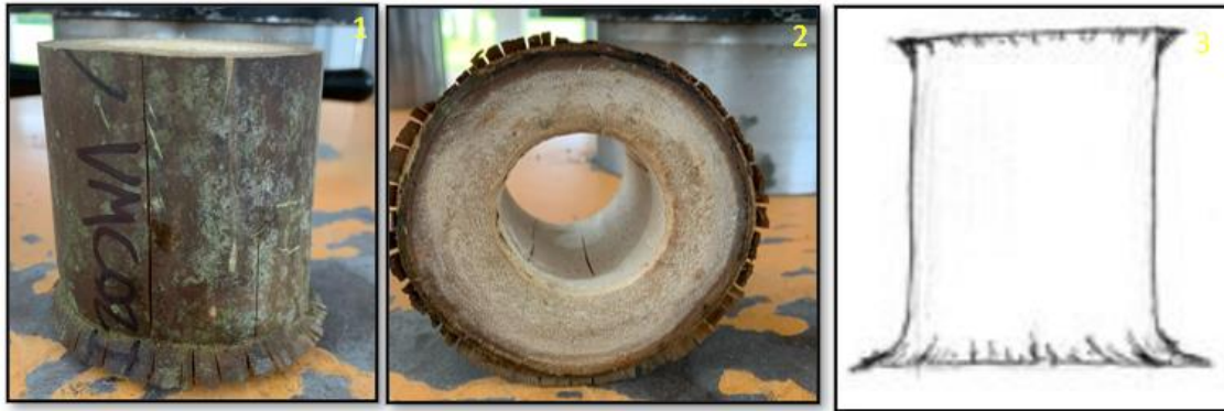
Figura 5 Falla de probeta por aplastamiento
