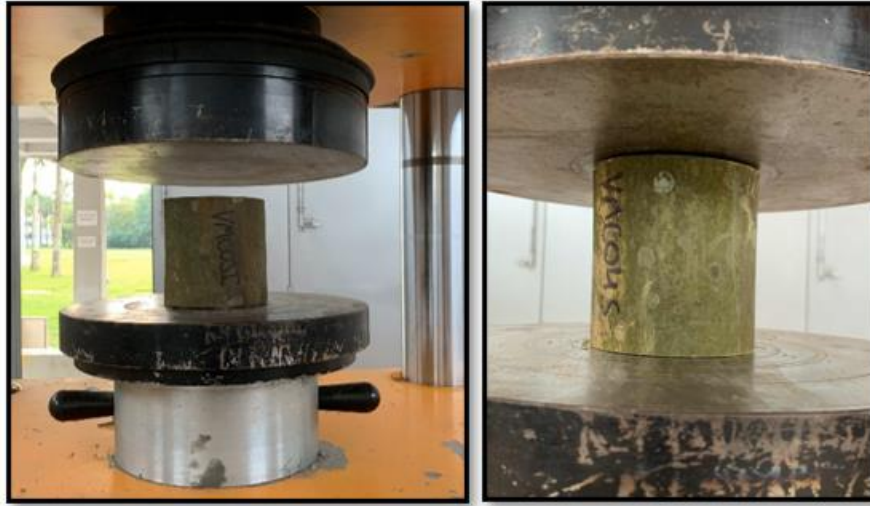
Figura 24 Montaje de probeta para el ensayo de compresión paralela a las fibras
