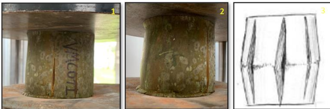
Figura 6 Falla de probeta por pandeo a las fibras en dirección exterior
