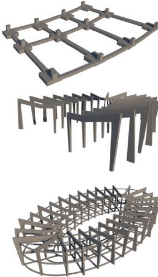
Figura 46. Isometrica del sistema estructural
