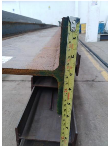
Imagen 23: Ancho de la aleta del perfil IPE
