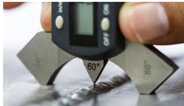
Imagen 48: Relieve de la soldadura
