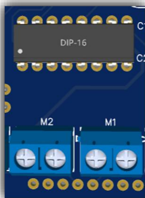
Figura 18. Modelo 3D submódulo controlador motores (driver) y terminales para los motores M1 y M2 – LockBikeRack Fuente: Autor
