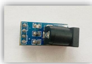
Figura 15. Módulo jack de corriente continua – LockBikeRack Fuente: Autor
