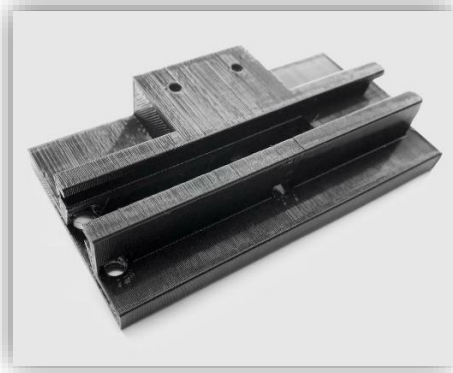
Figura 61. Impresión 3D soporte de pestillo perspectiva – LockBikeRack Fuente: Autor
