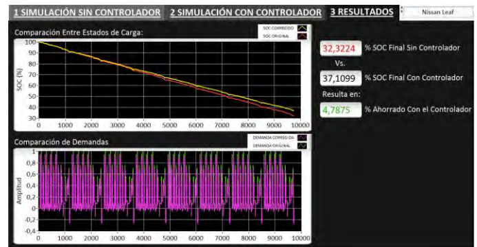
Fig. 14. Comparación de resultados en simulación para un Nissan Leaf
