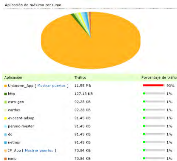
Fig. 7. Aplicación de máximo consumo cuando existe un ciber-ataque de escaneo de puertos en búsqueda de vulnerabilidades.
