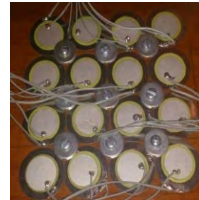
Ilustración 1: Láminas piezoeléctricas conectadas en paralelo (Fuente: Autores)
