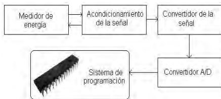
Figura 2. Diagrama de Adquisición de la señal digital del medidor.
