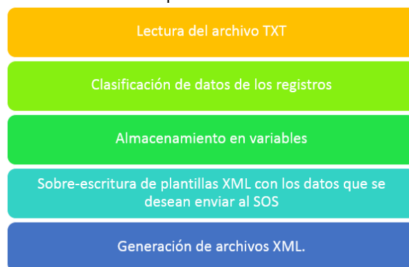
Fig. 11. Esquema general de funcionamiento del programa desarrollado en lenguaje JAVA para el parceo de archivos TXT a XML.
