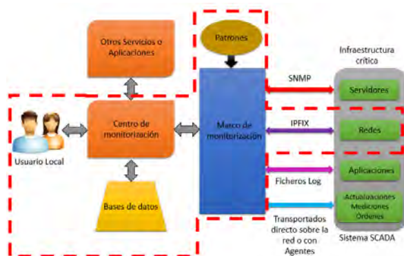
Fig. 1. Aplicación de la metodología BUGYO al entorno de monitorización para CIP propuesto en el actual trabajo.
