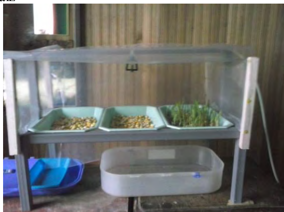
Fig12. Montaje físico final para el sistema de riego temporizado
