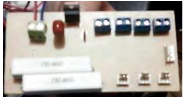
Fig. 7. Circuito físico del regulador de tensiones y fuente dual.
