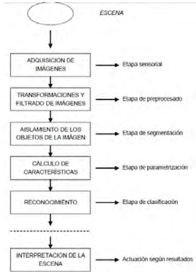
Fig. 1 Diagrama de bloque de un sistema de visión artificial
