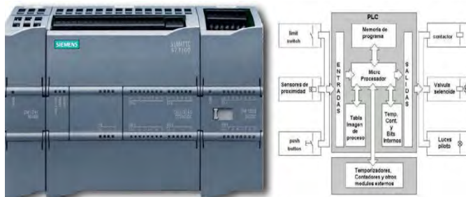
Fig.1. Imagen física y diagrama de bloques de un PLC
