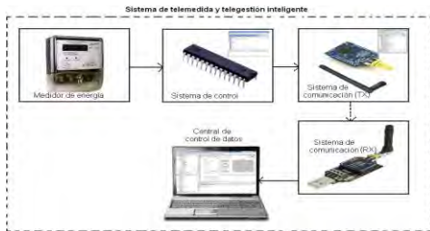
Figura 1. Diagrama de módulos del dispositivo.
