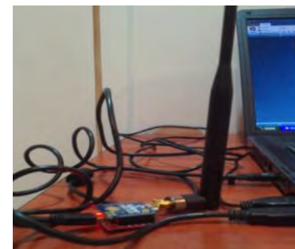
Figura 8. Receptor inalámbrico conectado al centro de control.
