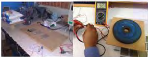
Fig. 7. Caracterización sensor de fuerza. Fuente: Autores
