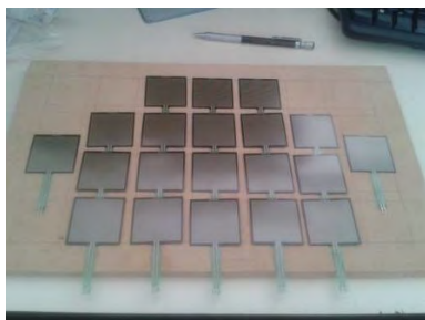
Fig. 3. Distribución de sensores resistivos. Fuente: Autores
