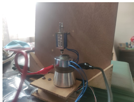
Figura 8.2: Soporte del solenoide y celda de carga
