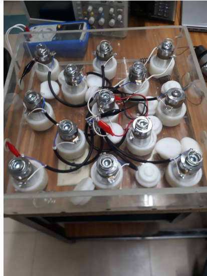
Figura 8.5: Conexión de los piezoeléctricos dentro de la baldosa
