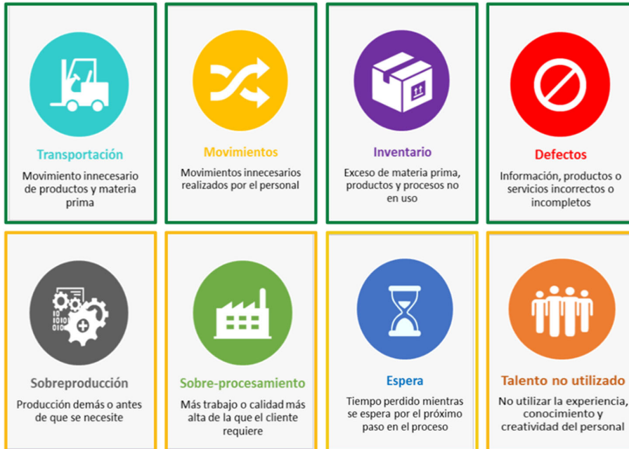
Imagen 7. Tipos de desperdicios en Lean y a que hacen referencia cada uno. Fuente Luis Fernando Botero Botero, 2021.
