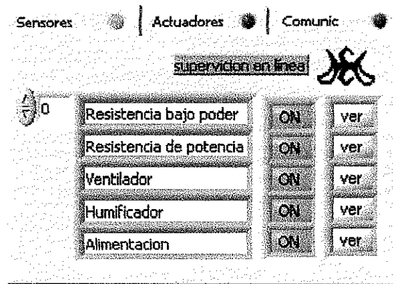
Figura 216 Panel de supervisión para el sistema base
