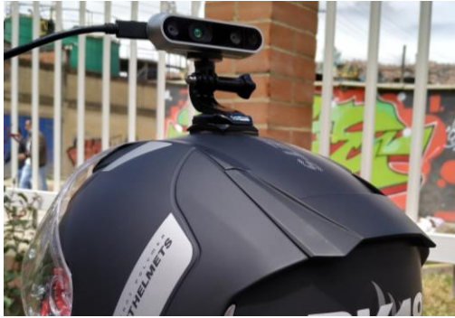
Figura 71. Cámara RealSense en el casco del motociclista, fuente autor
