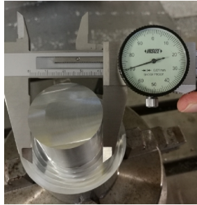
Figura 34. Control metrológico diámetro básico mayor para roscas externas
