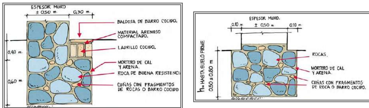
FIGURAS N. 25 y 26. Proceso Constructivo Tapia Pisada. Cimentación Manual para la Rehabilitación de Viviendas Construidas en Adoba y Tapia Pisada. Asociación Colombiana de Ingeniería Sísmica – AIS- Página 2 - 5
