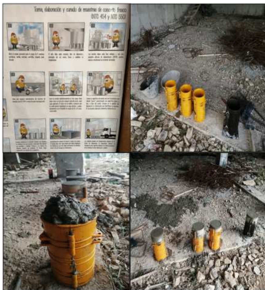
Ilustración 24: Procedimiento del ensayo de resistencia
