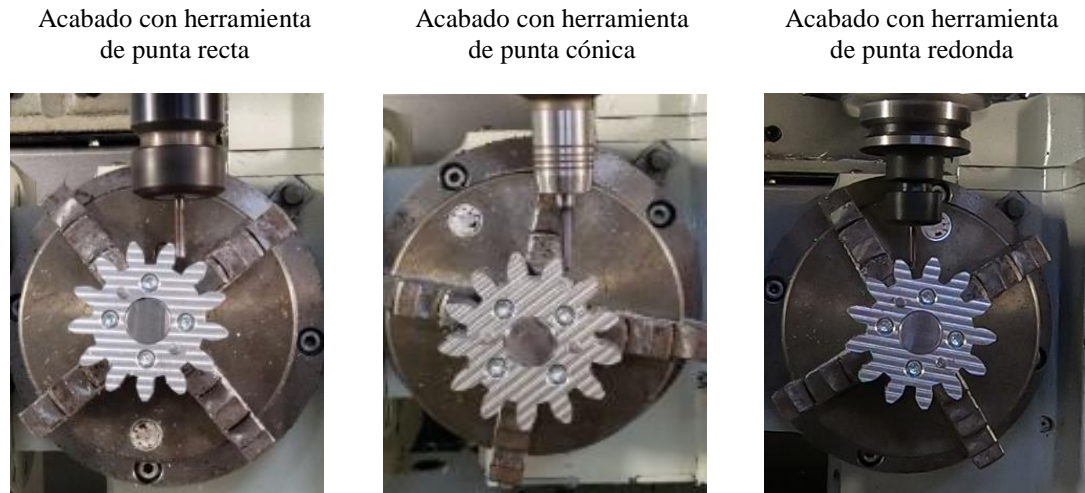
Figura 31. Acabado de los dientes de los engranajes.
