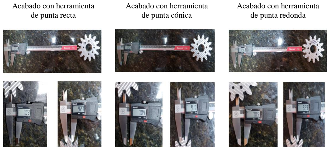
Figura 36. Metrología pie de rey digital engranajes con geometría obtenida desde Excel®
