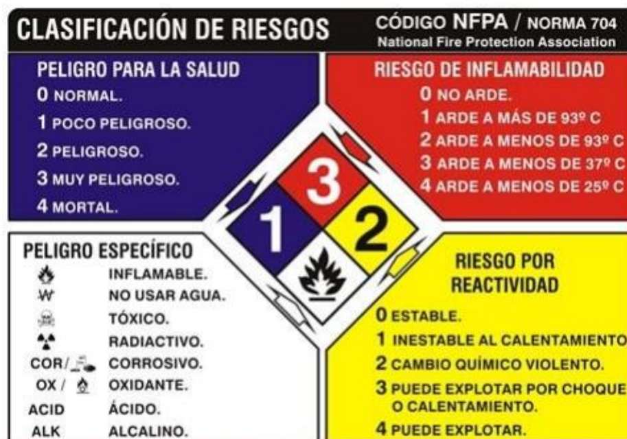
Figura 27. Rombo de seguridad
