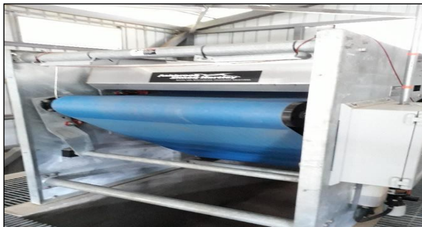
Figura 21. Fotografía filtro de banda hidráulica
