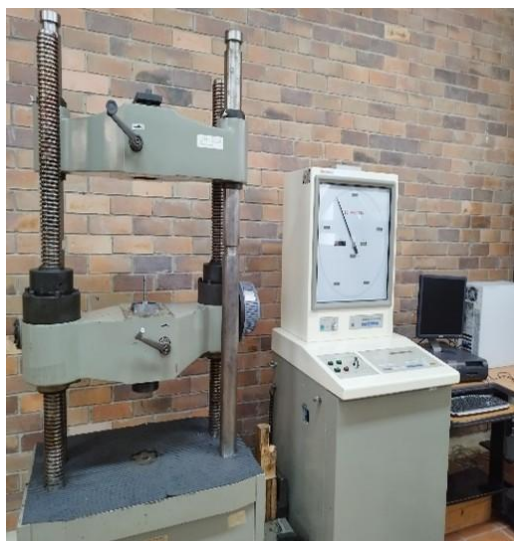
Fig. 7. Máquina universal Shimadzu 500K
