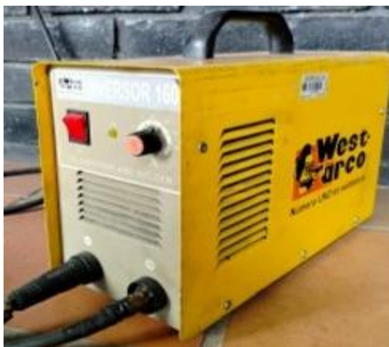
Fig. 14. Equipo de soldadura revestido de 160A. West Arco
