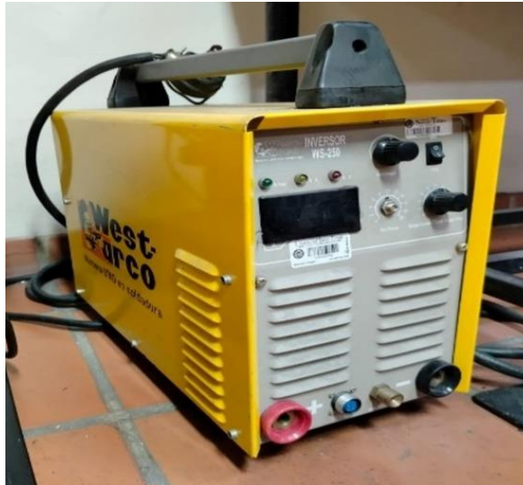
Fig. 15. Equipo inversor electrodo revestido De 250A. West Arco
