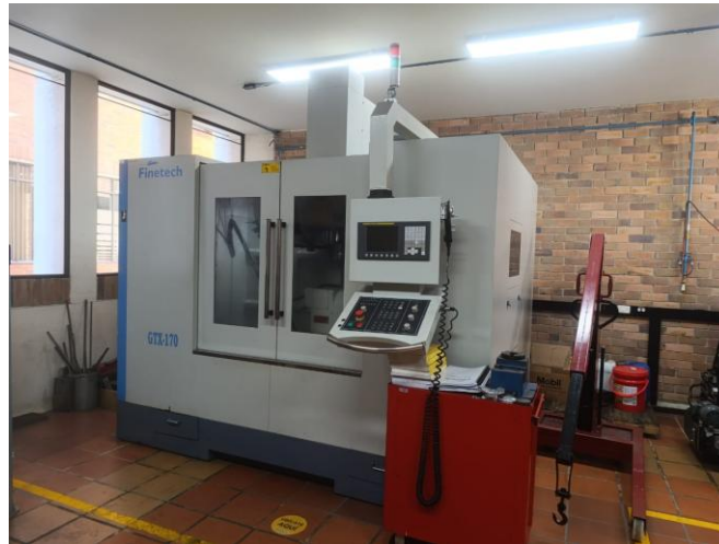
Fig. 3. Centro de mecanizado Finetech GTX 170
