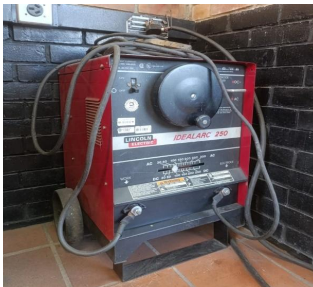
Fig. 13. Equipo soldador rectificador Lincoln 250A
