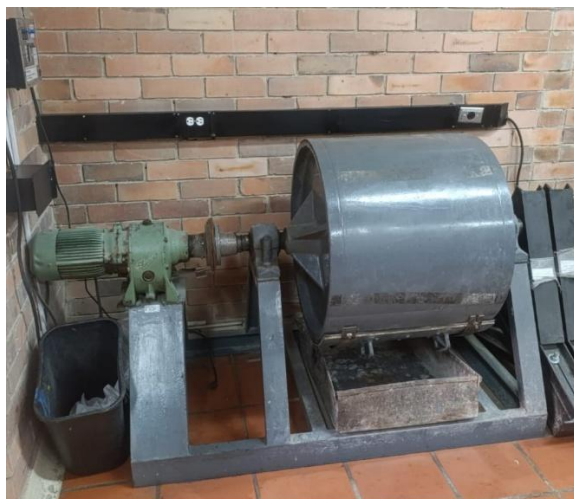
Fig. 4. Máquina de los ángeles con motor trifásico
