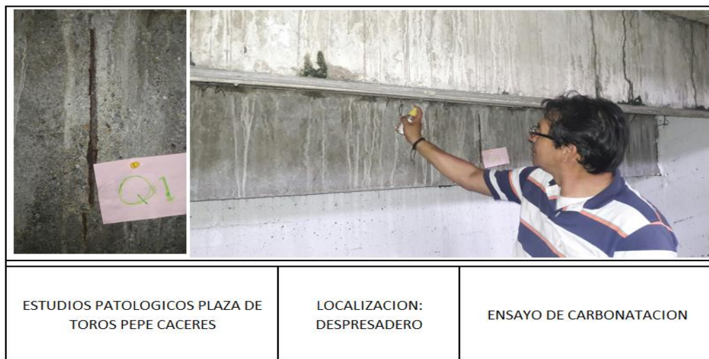
Imagen 21. Ensayo de carbonatacion con fenolftalina.
