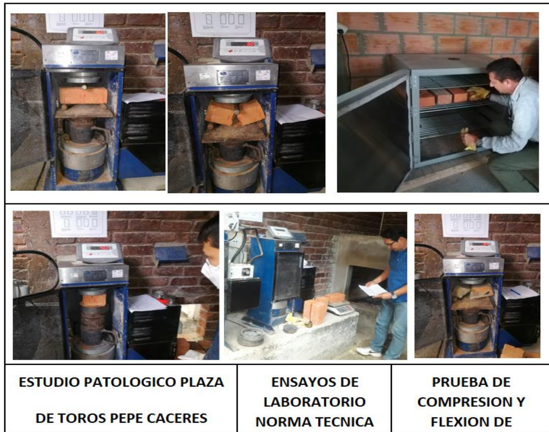
Imagen 23. Ensayo de compresion y flexion de ladrillo.
