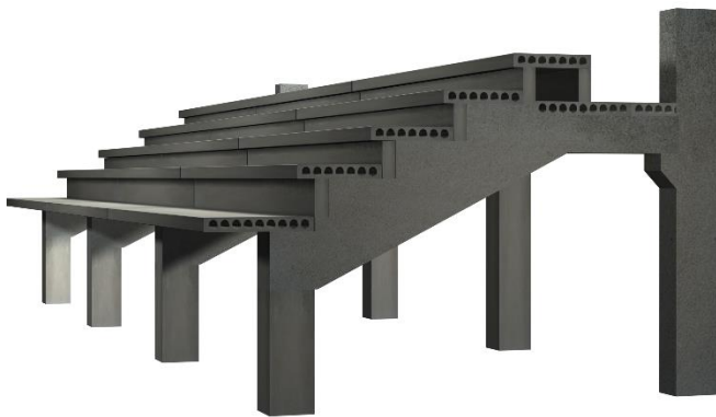
Imagen 9 Esquema de estructura para graderías
