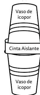
FIGURA 65. Sellado de vasos – Tercer nivel – Verificando la primera ley de la termodinámica
