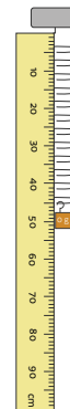
FIGURA 22. Medición de la longitud del resorte 1 estirado, inciso g – tercer nivel: aplicando la ley de Hooke
