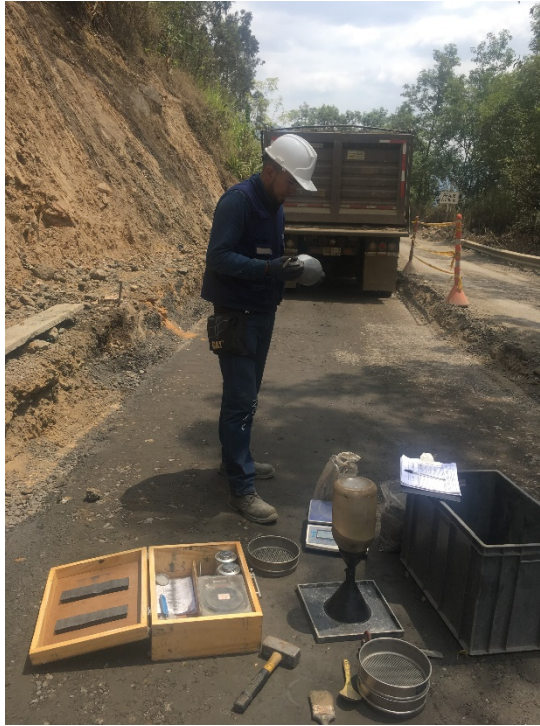
Fotografía 3. Toma de densidades con cono y arena.
