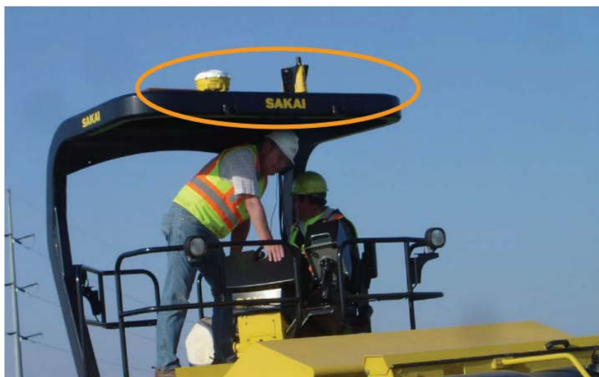
Figura 10. Receptor y antena RTK GPS sobre un rodillo Sakai.
