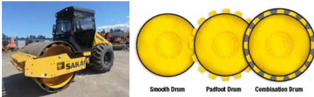
Figura 8. Rodillo IC patecabra de Sakai con juego de carcasas lisas.
