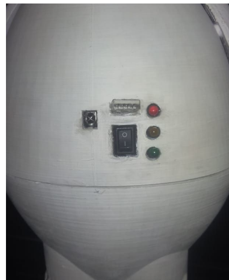
Figura 24. sensor infrarrojo , USB, led y Switch
