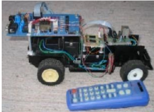
Figura 11. Robot móvil operado por medio de señales infrarrojas. Autor:Irma Perez Salinas[14].
