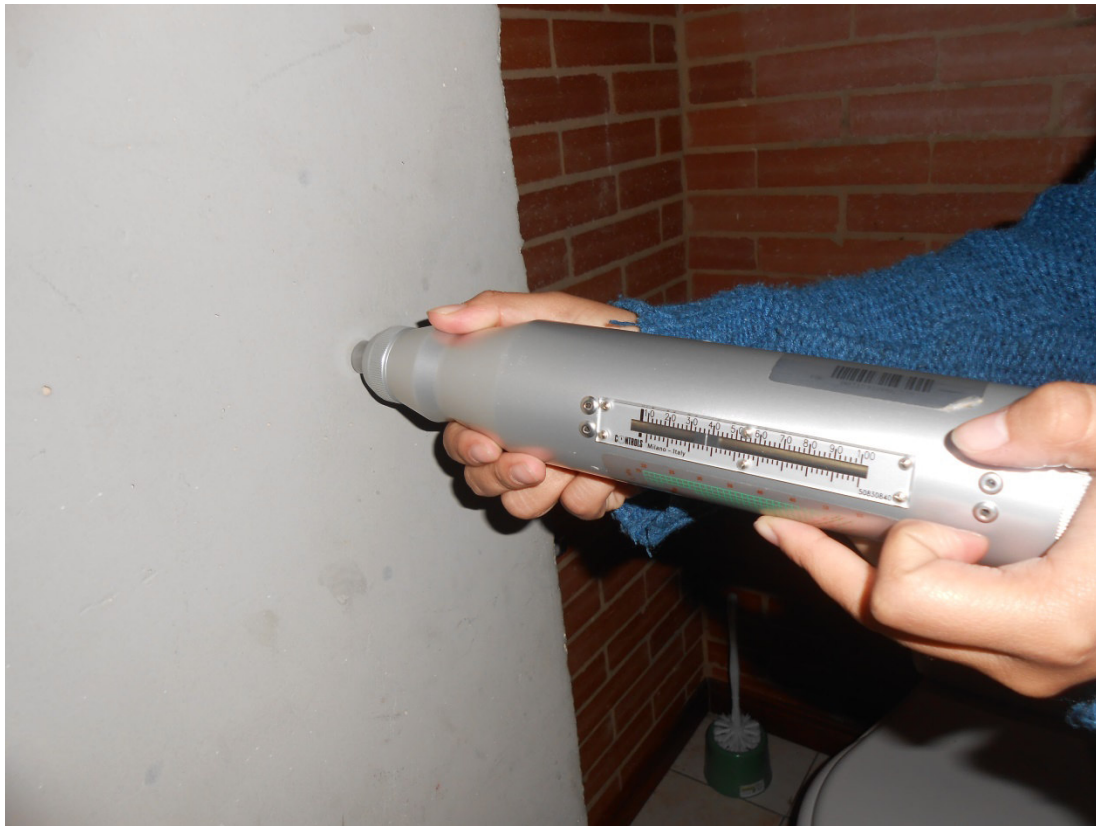
Figura. 32 Ejecución de ensayo de esclerometría
