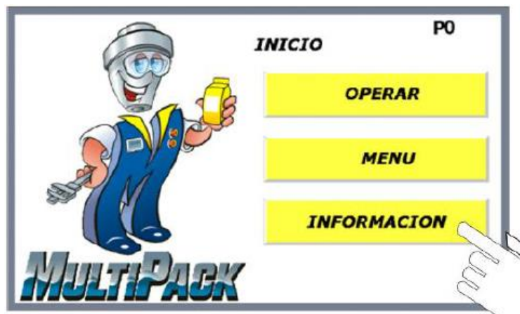
Figura 5. Diseño de las pantallas de operación de la máquina empacadora en 2014.
