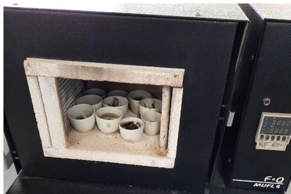
Figura 10. Determinación de solidos totales volátiles.
