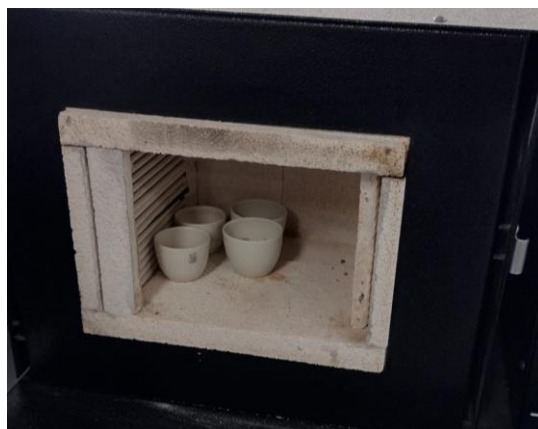
Figura 12. Determinación de solidos totales volátiles del co-sustrato (caña de azúcar)
