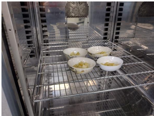
Figura 11. Determinación de sólidos totales (ST) del co-sustrato (caña de azúcar).
