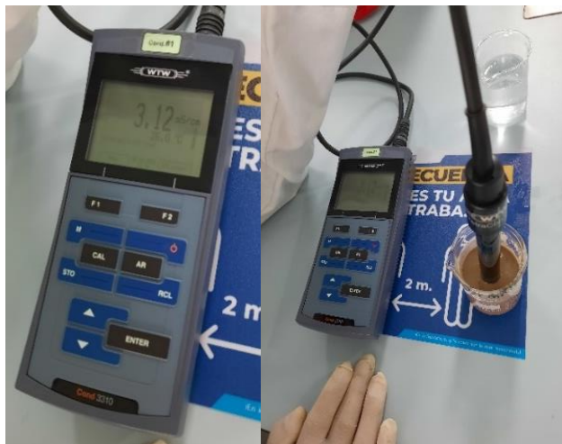
Figura 7. Medición de Conductividad de excretas porcinas.
