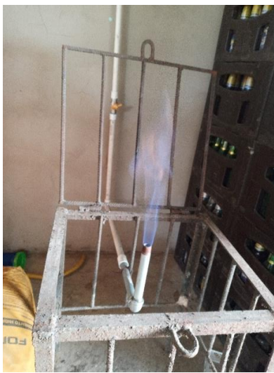
Figura 26. Quemador adaptado para el biogás.
