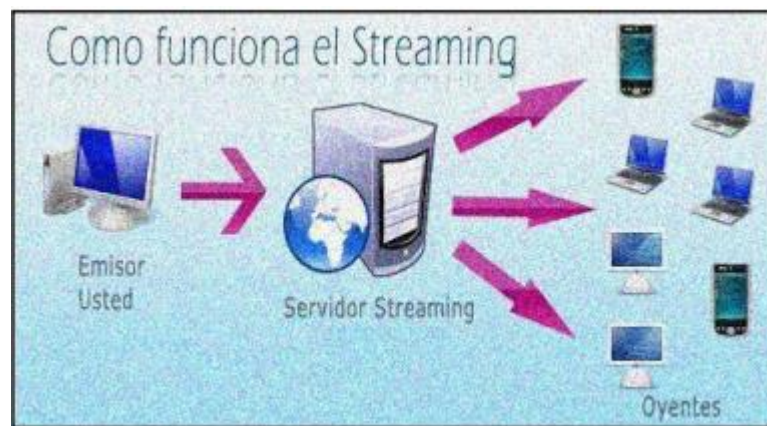
Figura 34. FUNCIONAMIENTO DE LA RADIO VÍA STREAMING
