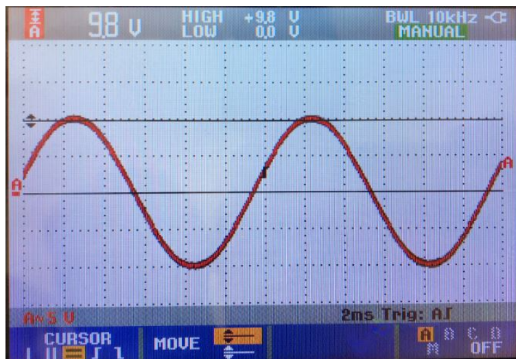
Figura 6-24.: Resultados implementación con conexión en estrella de voltaje del generador con R = 5\Omega y V = 7,5\text{m/s}
