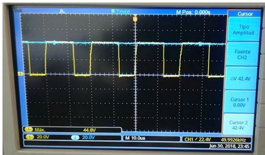
Figura 7-10.: Respuesta de conmutación del MOSFET (Amarillo) y voltaje de salida (Azul) del sistema con una velocidad del viento de 14\text{ m/s}
