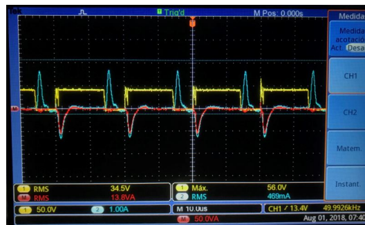
Figura E-14.: Voltaje en el Diodo 3 (Amarillo), corriente en el Diodo 3 (Azul) y potencia en el Diodo 3 (Rojo)
