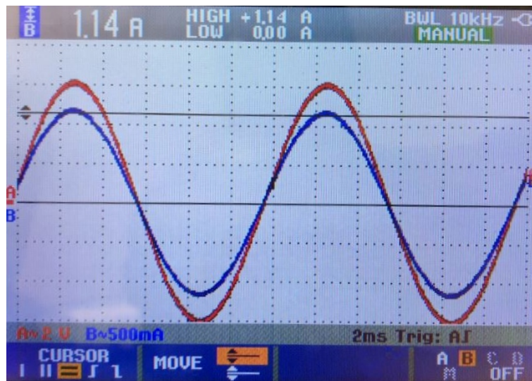
Figura 6-26.: Resultados implementación con conexión en estrella de corriente en la resistencia con R = 5 \Omega y V = 7,5 \text{ m/s}
