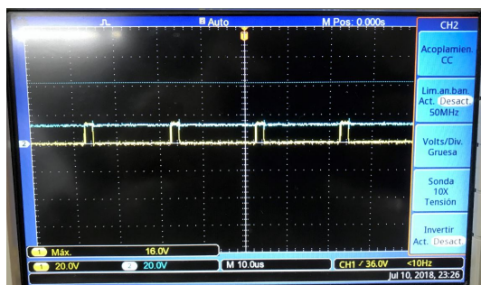
Figura 7-22.: Respuesta de conmutación del MOSFET (Amarillo) y voltaje de salida (Azul) del sistema con una entrada de 5 V
