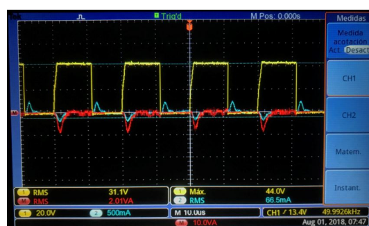
Figura E-18.: Voltaje en el mosfet (Amarillo), corriente en el mosfet (Azul) y potencia en el mosfet (Rojo)
