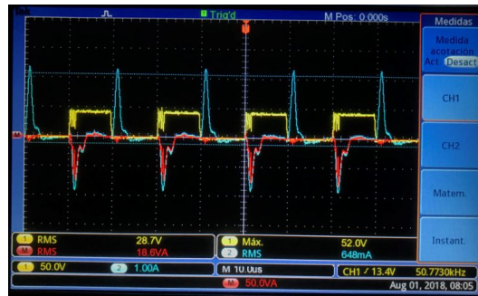
Figura E-28.: Voltaje en el Diodo 3 (Amarillo), corriente en el Diodo 3 (Azul) y potencia en el Diodo 3 (Rojo)
