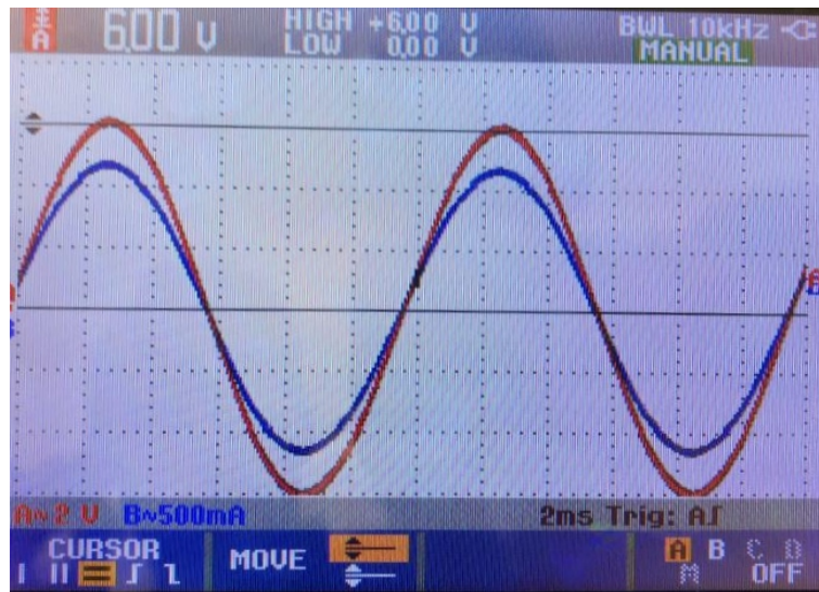
Figura 6-25.: Resultados implementación con conexión en estrella de voltaje en la resistencia con R = 5 \Omega y V = 7,5 \text{ m/s}
