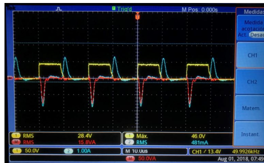
Figura E-21.: Voltaje en el Diodo 3 (Amarillo), corriente en el Diodo 3 (Azul) y potencia en el Diodo 3 (Rojo)
