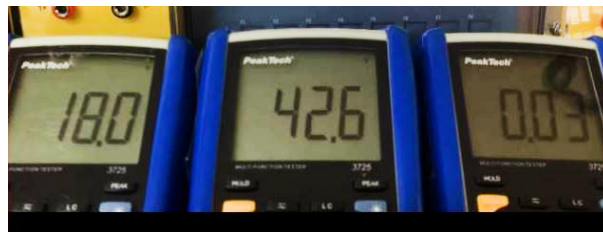
Figura 7-11.: (De izquierda a derecha) Voltaje de entrada al convertidor, voltaje de salida del convertidor, corriente de entrada al convertidor con una con una velocidad del viento 14\text{ m/s}
