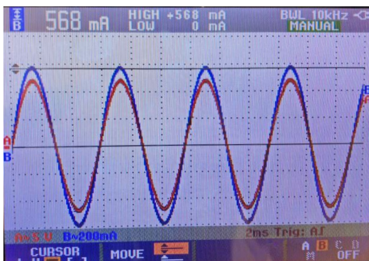
Figura 6-18.: Resultados implementación con conexión en estrella de corriente en la resistencia con R = 20 \, \Omega y V = 14,5 \, \text{m/s}
