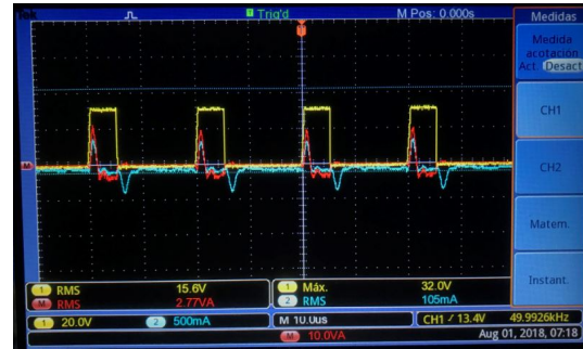
Figura E-6.: Voltaje en el Diodo 2 (Amarillo), corriente en el Diodo 2 (Azul) y potencia en el Diodo 2 (Rojo)
