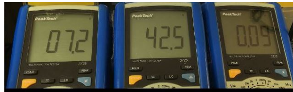
Figura 7-9.: (De izquierda a derecha) Voltaje de entrada al convertidor, voltaje de salida del convertidor, corriente de entrada al convertidor con una con una velocidad del viento 6\text{ m/s}
