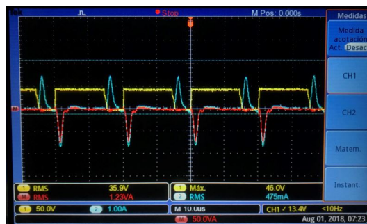
Figura E-7.: Voltaje en el Diodo 3 (Amarillo), corriente en el Diodo 3 (Azul) y potencia en el Diodo 3 (Rojo)
