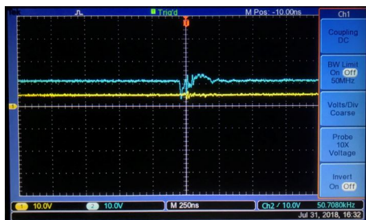
Figura E-3.: Voltaje de entrada al driver de 5V (Amarillo) y Voltaje de entrada al driver de 12V (Azul)
