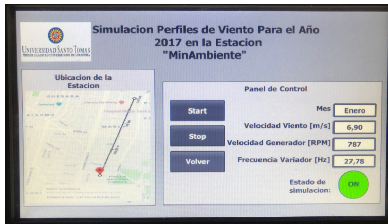
Figura 6-4.: Modo de operación automático para una de las estaciones en la HMI
