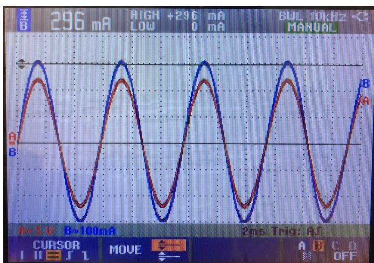
Figura 6-14.: Resultados implementación con conexión en estrella de corriente en la resistencia con R = 40 \, \Omega y V = 14,5 \, \text{m/s}
