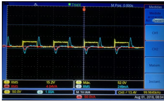
Figura E-26.: Voltaje en el Diodo 1 (Amarillo), corriente en el Diodo 1 (Azul) y potencia en el Diodo 1 (Rojo)
