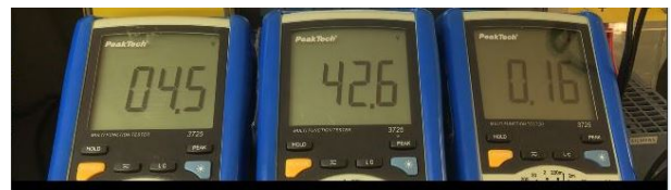
Figura 7-7.: (De izquierda a derecha) Voltaje de entrada al convertidor, voltaje de salida del convertidor, corriente de entrada al convertidor con una con una velocidad del viento 3,8\text{ m/s}
