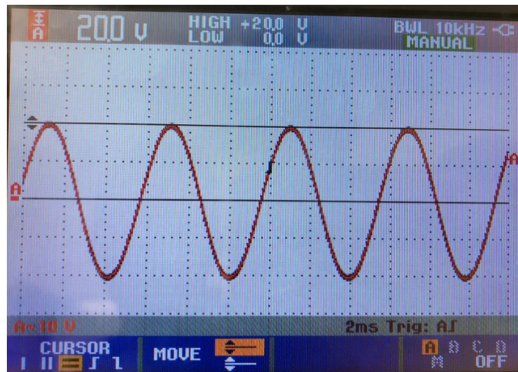
Figura 6-20.: Resultados implementación con conexión en estrella de voltaje del generador con R = 10 \, \Omega y V = 14,5 \, \text{m/s}
