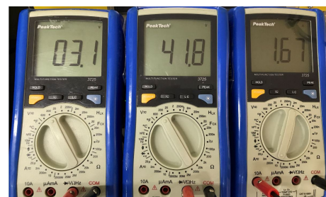
Figura 7-17.: (De izquierda a derecha) Voltaje de entrada al convertidor, voltaje de salida del convertidor, corriente de entrada al convertidor con una con una entrada de 5 V
