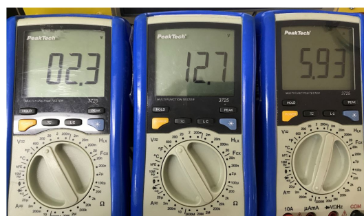
Figura 7-23.: (De izquierda a derecha) Voltaje de entrada al convertidor, voltaje de salida del convertidor, corriente de entrada al convertidor con una con una entrada de 5 V
