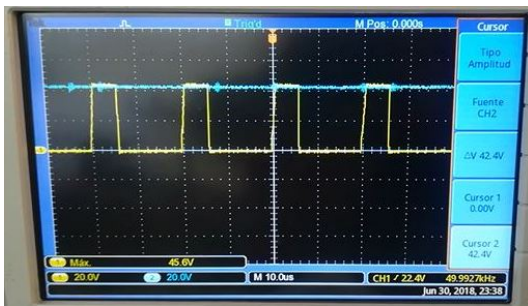
Figura 7-6.: Respuesta de conmutación del MOSFET (Amarillo) y voltaje de salida (Azul) del sistema con una velocidad del viento de 3,8\text{ m/s}
