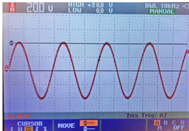
Figura 6-16.: Resultados implementación con conexión en estrella de voltaje del generador con R = 20 \, \Omega y V = 14,5 \, \text{m/s}
