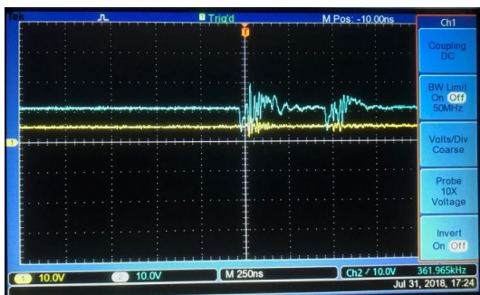
Figura E-24.: Voltaje de entrada al driver de 5V (Amarillo) y Voltaje de entrada al driver de 12V (Azul)
