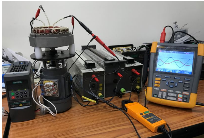
Figura 6-10.: Implementación del sistema PMSG con carga en configuración estrella
