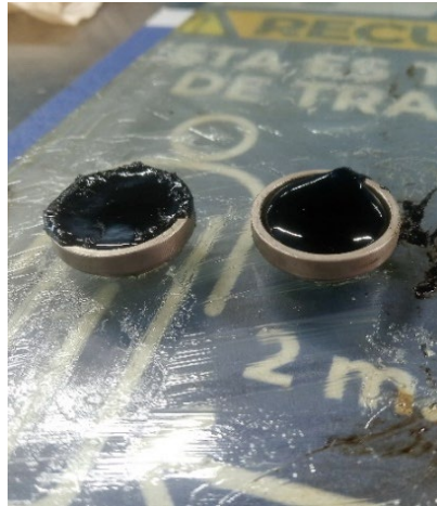
Figura 7.14 Anillos metálicos con muestra de asfalto modificado
