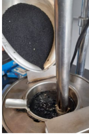
Figura 7.7 Proceso de modificación del asfalto
