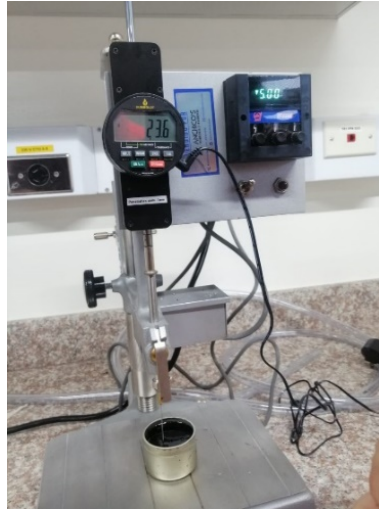
Figura 7.10 Ensayo de penetración
