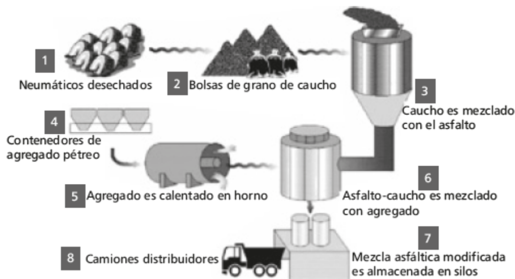
Figura 6.2 Proceso de fabricación del asfalto-caucho (vía húmeda).
