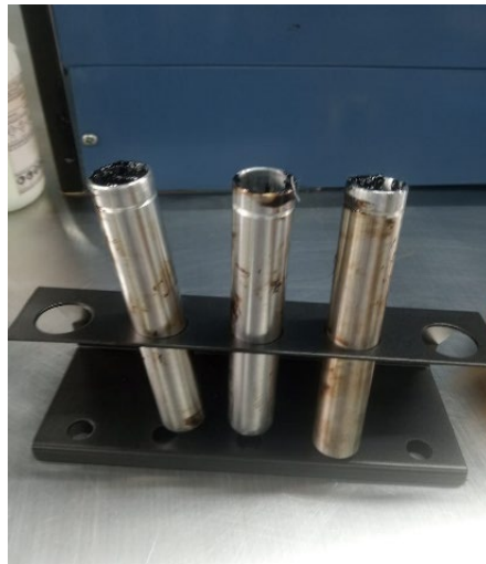
Figura 7.17 Vástagos cilíndricos con muestra de asfalto modificado
