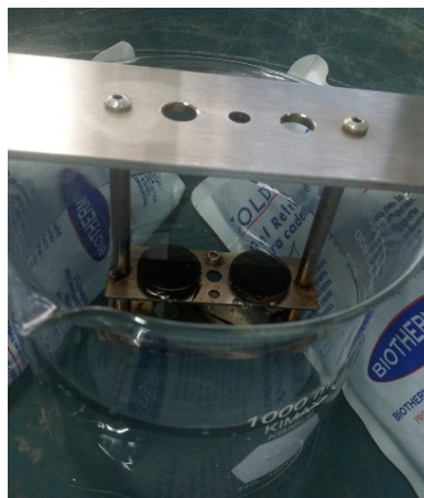
Figura 7.15 Montaje del ensayo de punto de ablandamiento
