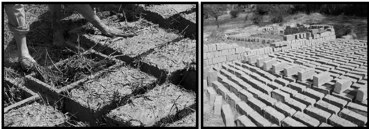
Figura 8. Proceso del adobe fresco, al retirarse del molde de madera, se aprecia el tamo y patio de secado al sol
