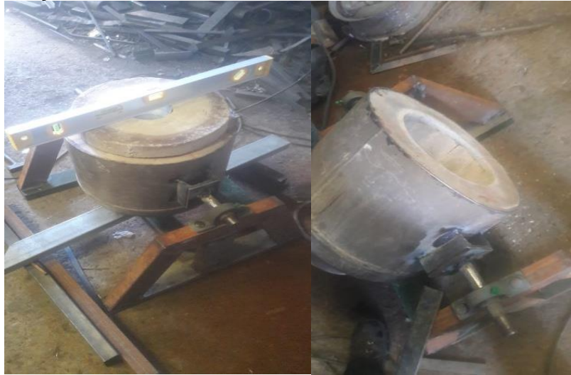
Figura 48. Montaje de la cámara de fundición.
