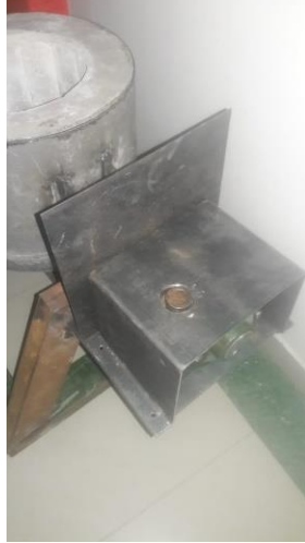
Figura 50. Ensamble del reductor como sistema de basculación.
