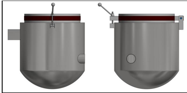
Figura 7. Vistas de cámara de fundición – Alternativa uno.
