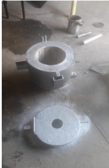
Figura 52. Ajuste de crisol y pintura.
