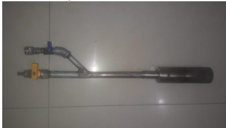
Figura 46. Construcción del soplete.
