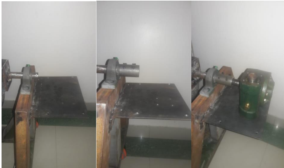
Figura 49. Ensamble del reductor como sistema de basculación.
