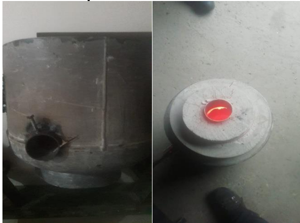
Figura 45. Construcción de la tapa del horno.
