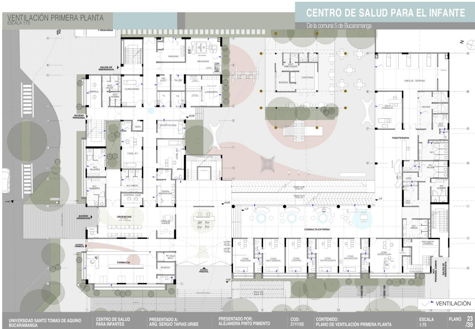
Figura 114. Plano de ventilación de primera planta.
