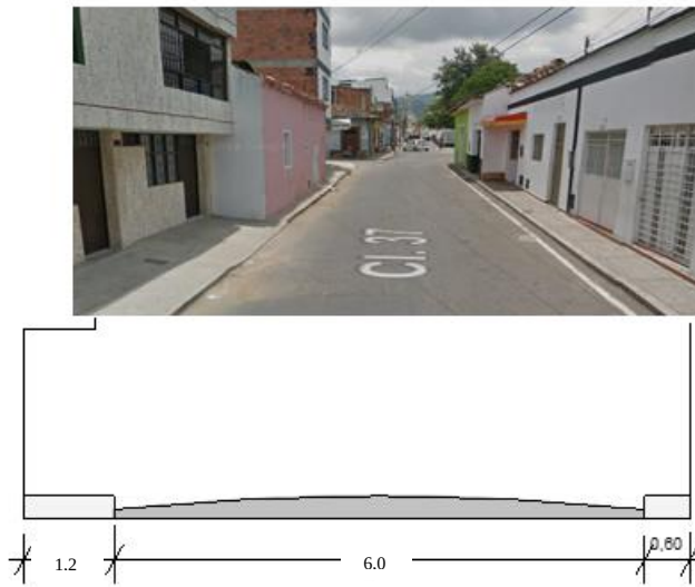
Figura 22. Medidas estado actual Calle 37, Bucaramanga.
