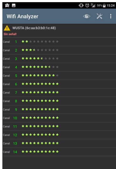
Imagen 10. Puntuación de los canales usados por las redes inalámbricas alrededor de la zona de Ping Pong.
