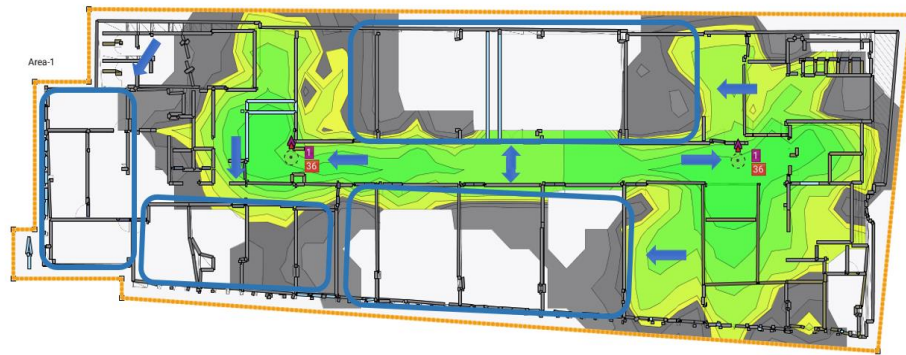
Figure 34 - señalización de lugares con poca o nula cobertura del cuarto piso del C.
