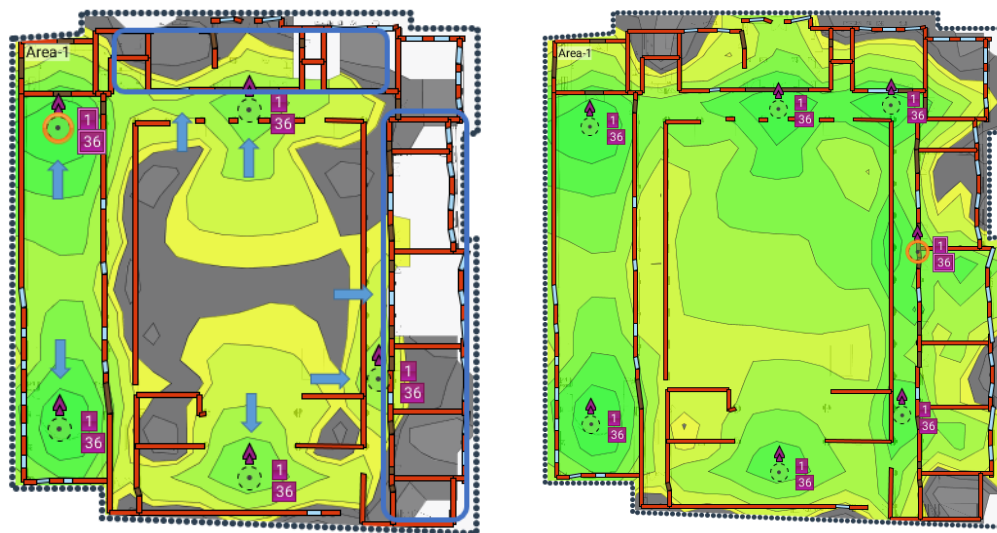
Figure 74 - Comparación del diseño actual de la red inalámbrica (izquierda) frente al diseño propuesto (derecha) para el primer piso del A.
