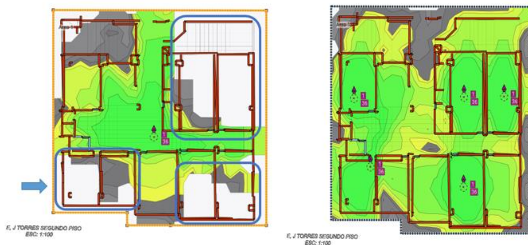
Figure 79 - Comparación del diseño actual de la red inalámbrica (izquierda) frente al diseño propuesto (derecha) para el segundo piso del B.
