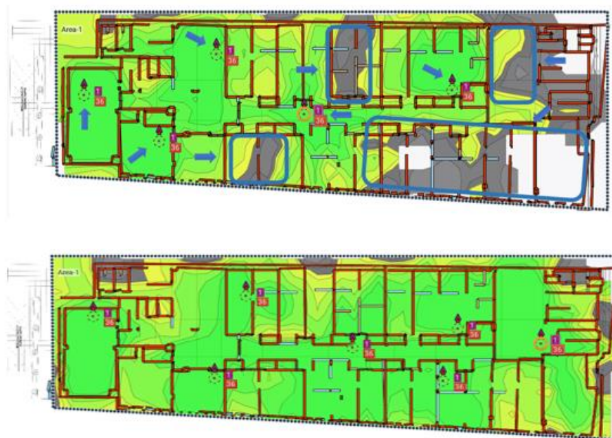
Figure 89 - Comparación del diseño actual de la red inalámbrica (arriba) frente al diseño propuesto (abajo) para el quinto piso del C.
