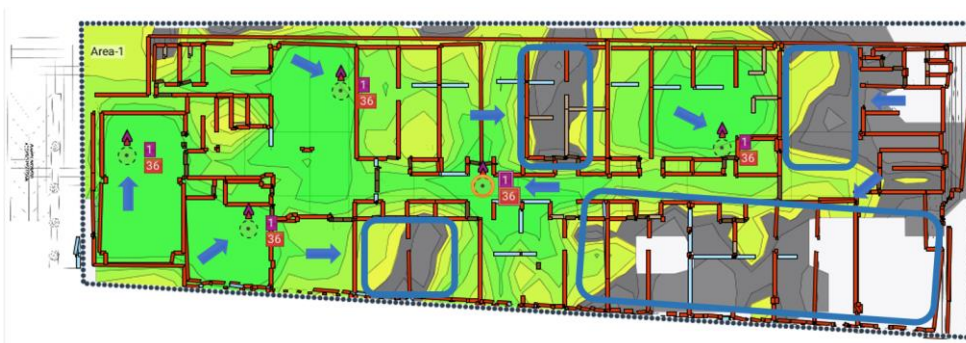
Figure 37 - señalización de lugares con poca o nula cobertura del quinto piso del C.
