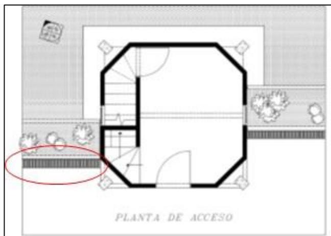
Figura 22. Localización fallo de sumidero.
