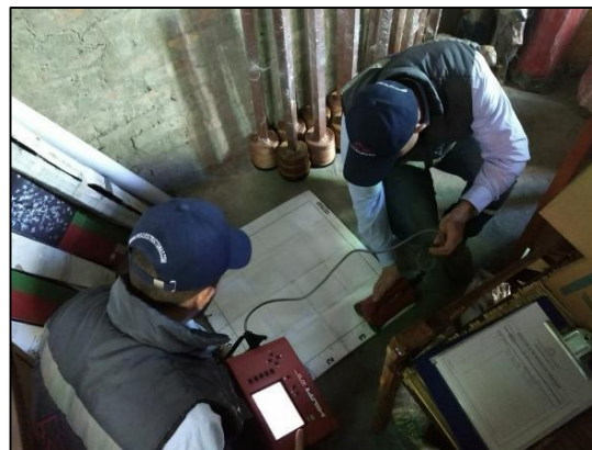
Figura 36. Ensayo de ultrasonido en placa de entrepiso en cara superior.
