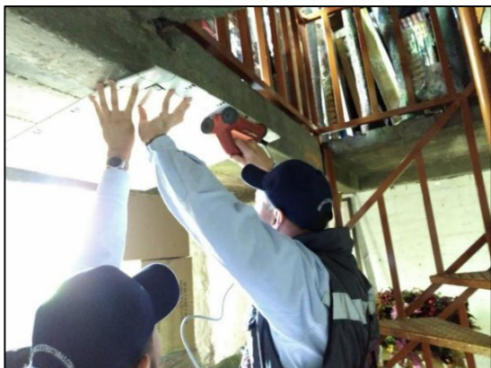
Figura 35. Ensayo de ultrasonido en viga de entrepiso por cara inferior.
