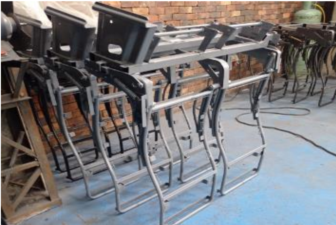
Ilustración 1. Estructura metálica para silla ARWILL nueva.
