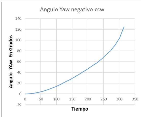
Grafica 4. Respuesta en lazo abierto del sistema físico y simulado con velocidad de los motores 1 y 3 al 50% de su velocidad y los motores 2 y 4 al 15 % de su velocidad.
