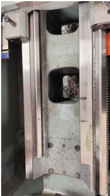
Limpieza de la bancada
