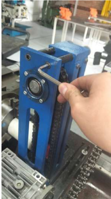
Reapriete de elementos de fijación
