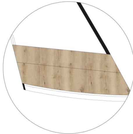
Figura 70. Detalle de listones de madera a cuerpo metálico prefabricado
