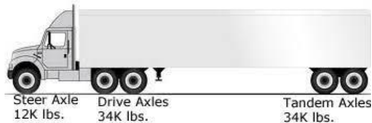
Figura 8. Especificaciones de los pesos permitidos de los camiones en EEUU
