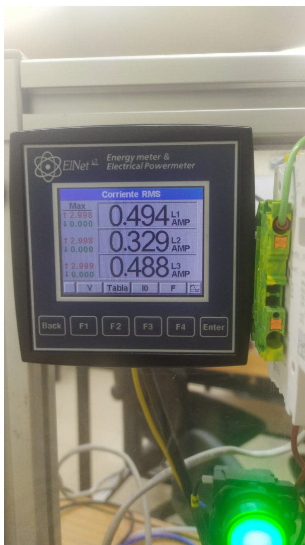
FIGURA 55: Corriente mostrada en el circutor al momento de bloquear el rotor. Autoría propia
