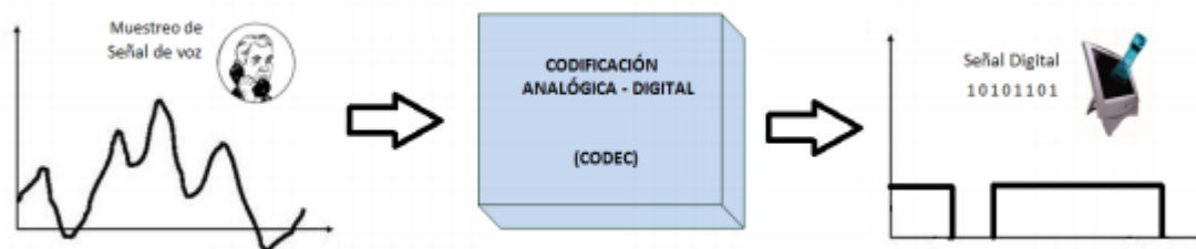
Figura 1. Conversión de una Señal Analógica a Digital. Adaptado de reyes Augusto, F. C. (2010). Fundamentos y arquitectura de una red VoIP EPN, Quito.
