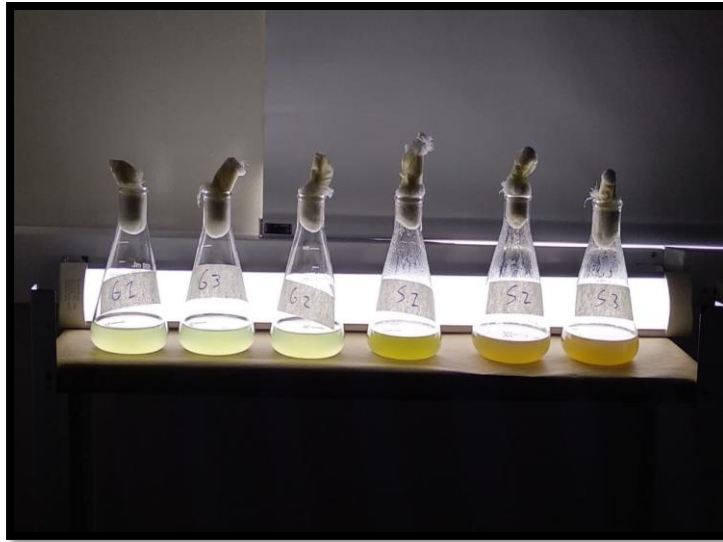
Figura 2. Medio de cultivo en fotobiorreactores. Por, autores 2018
