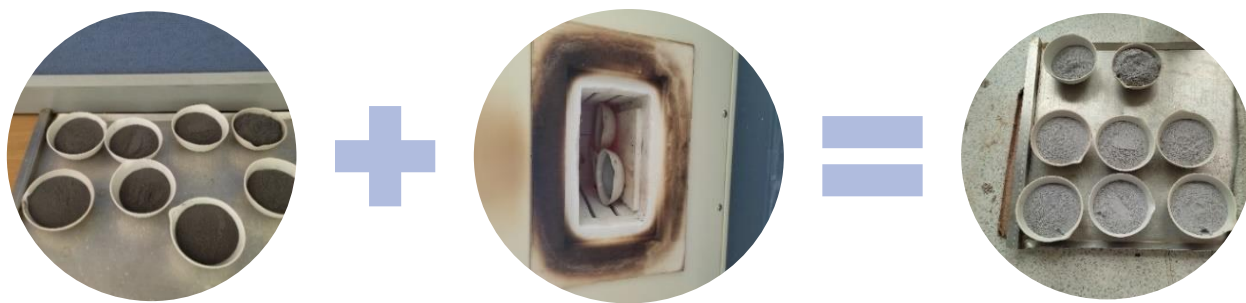
Figura 5. Muflas con la muestra de ceniza antes y después de la calcinación.
