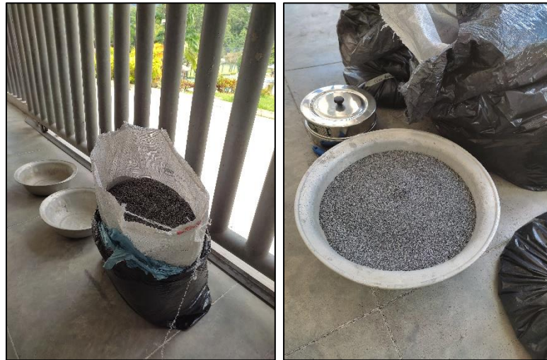
Figura 3. Ceniza de cascarilla de arroz en laboratorio de Ingeniería Civil.
