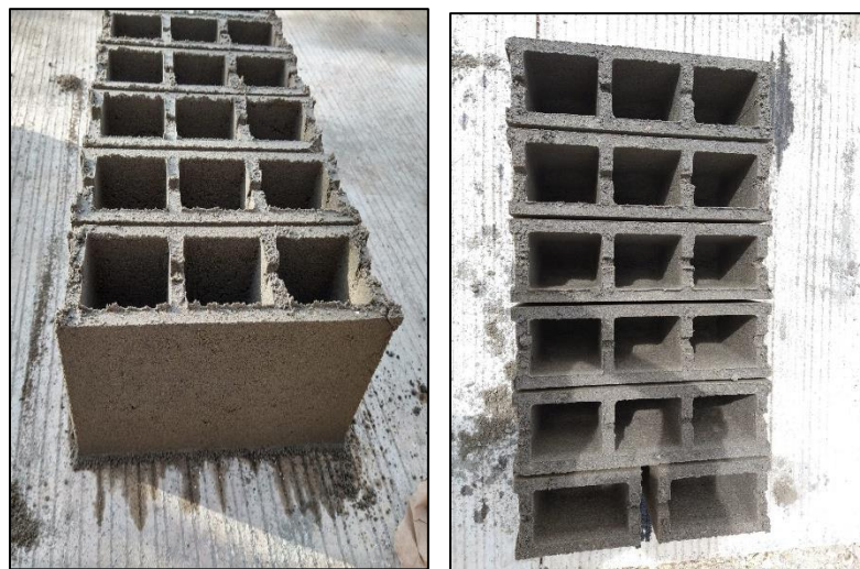
Figura 12 Apariencia y acabado de los ladrillos sin ceniza
