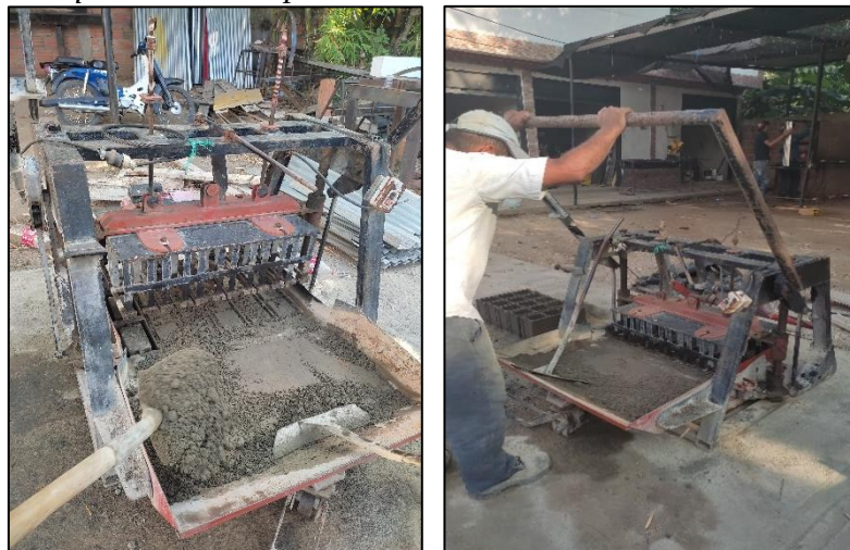
Figura 8. Máquina de bloques Vibro compactadora
