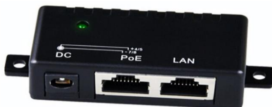
Figura 25 Adaptador de conexión por medio de puerto PoE. (Martí, 2013).
