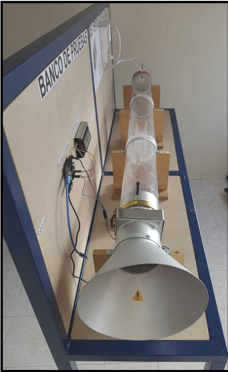
Figura 63. Vista frontal- techo construcción y ensamble final del banco de pruebas
