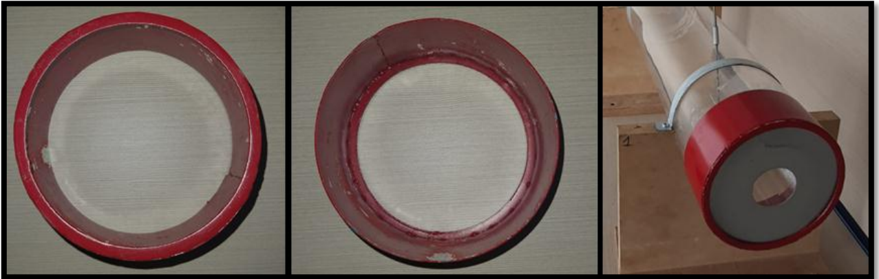
Figura 39. Matriz que soporta los anillos del estrangulador de flujo instalado
