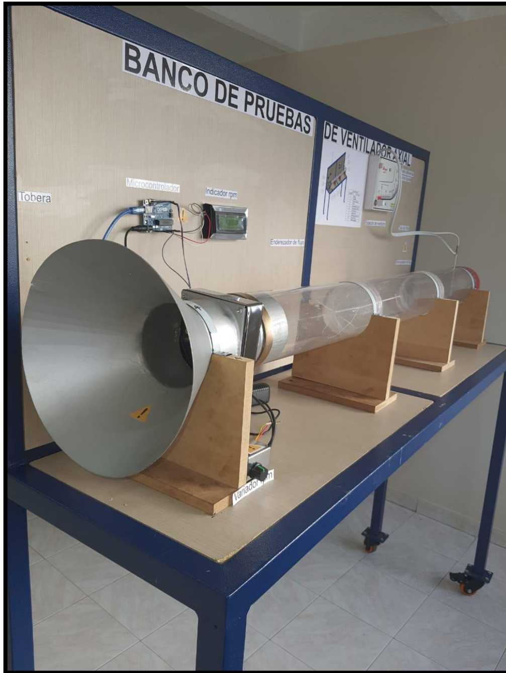
Figura 61. Vista frontal construcción y ensamble final del banco de pruebas
