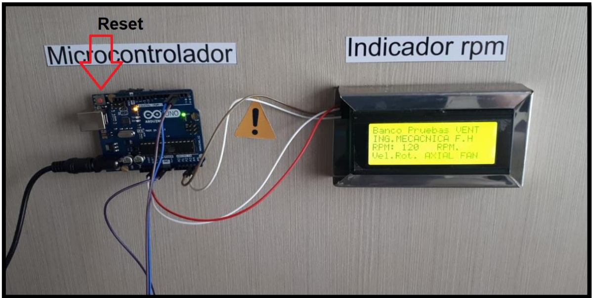
Figura 11. Botón de reset del microcontrolador Arduino
