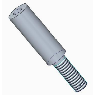
Figura 29. Eje para la conexión eléctrica. Autor.
