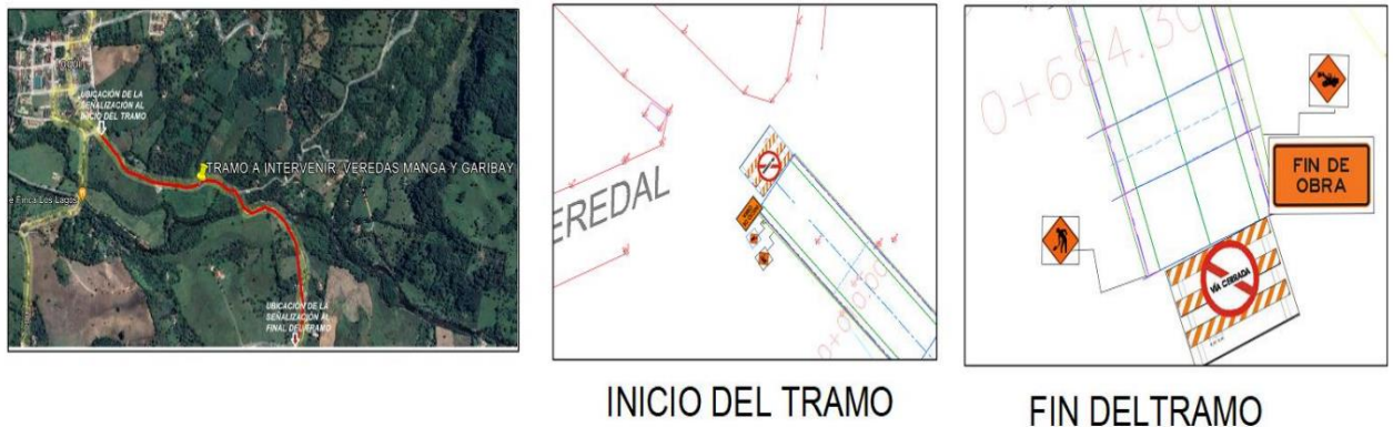
Figura 23. Fragmento PMT (Plan de Manejo de Transito) vías alternas y señalización implementadas veredas Manga y Garibay
