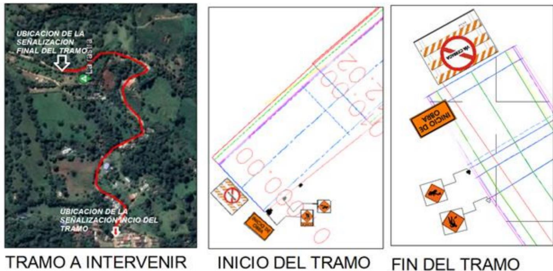
Figura 21. Fragmento PMT (Plan de Manejo de Tránsito) - vías alternas, Vereda Carare.
