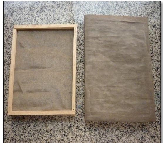
Imagen 2. Filtros en malla tipo Mesh
